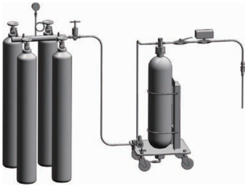
图 5 高压粒子发生器设计图 Fig. 5 Schematic diagram of high pressure particle generator
